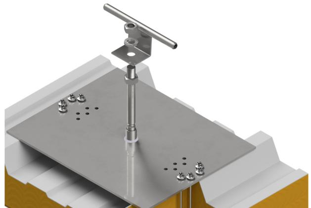
5. Soll ein Seilsystem auf den Primo 47 SP montiert werden, so muss der Seilzwischenhalter oder Kurve zwischen den beiden mitgelieferten Muttern festgeschraubt werden. Die Obere Mutter zusätzlich mit einem Federling sichern. Diese Muttern unbedingt mit hochfester Schraubensicherung sichern.
