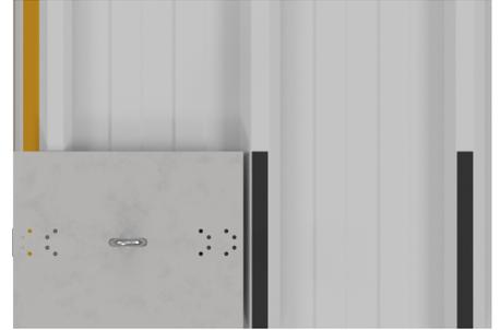
3. Kleben Sie die zweite mitgelieferte Dichtung im Bereich der Anschlagereinrichtung auf die benachbarte Hochsicke der Sandwichpaneel.
